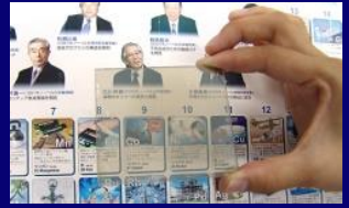
分子プレカーサー法で初めて形成したスピネル型 \text{Co}_3\text{O}_4 薄膜
