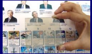
分子プレカーサー法で初めて形成したスピネル型 \text{Co}_3\text{O}_4 薄膜
