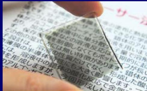
銅錯体溶液の塗布・低温熱処理で、ガラス基板によく密着した低抵抗な銅薄膜を形成しました。透過率や反射率など、膜厚で制御できます。
