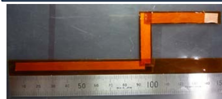
図1 模式図(上)と実際のプラズマアクチュエータ(下)
