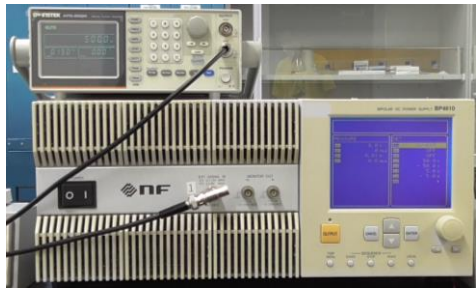
Fig.3 ファンクションジェネレータ(上)とパワーサプライ(下)
