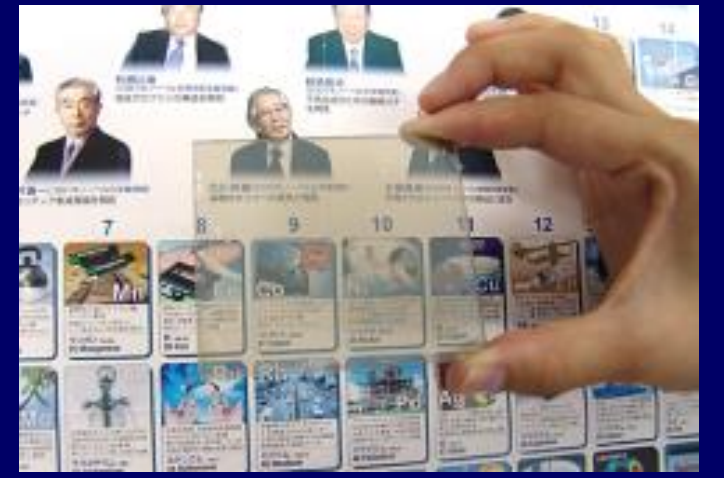
分子プレカーサー法で初めて形成したスピネル型 \text{Co}_3\text{O}_4 薄膜
