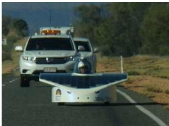
バッテリーが復活したチームはソーラーカーを走らせて、前夜から改良を進めたダウンフォースの改善結果を検証したい。ソーラーカーの走行を開始して 70km 巡航で進んでいく。そのスピードに対して約 300W のエネルギーの削減ができた。Alice Springs のコントロールストップに 15:00 頃に到着。初日終了時の時速 60km~65km での消費と比べれば、同じ消費で時速 70km 後半から 80km までの巡航領域で走行できそうだ。昨日の改良が効果あることが判明していく。しかし、トップチームは時速 100km/h 以上の巡航スピードで走行している情報が入る。やはり前方投影面積を計算に入れて面積の減算分を消費に掛け算すると薄型にすれば巡航スピード 100km/h が出せることになる。コンセプトや安全性よりも、勝負のためにスティックに速度を重視した設計にしなければこの世界大会に勝てない。この日、1583km 付近の Stuarts Well のロードハウスに停車してキャンプをすることになる。
