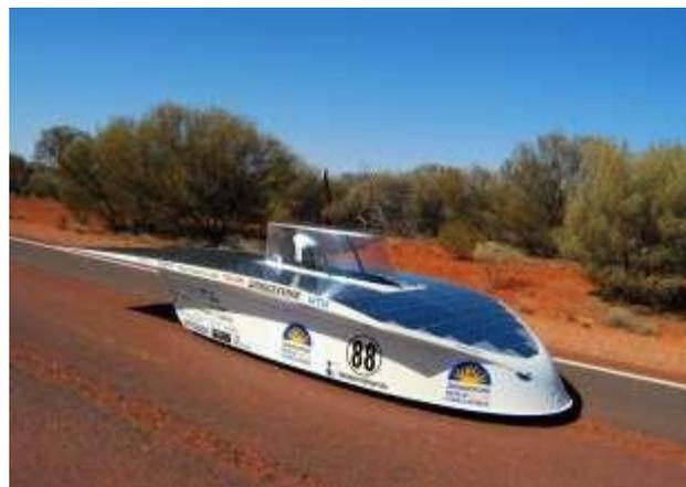
レース中の工夫によって、ようやく走行距離を 575km まで伸ばすことができた。レース中は考えられる案の組み合わせを見つけることだった。1) サス調整、2) ボディーに穴をあける、3) ノーズからダクトを出してボディー穴に空気を流してダウンフォースを打ち消す、4) 後輪タイヤハウスを外してノーズとボディー穴から入った空気を後輪側へ逃がす。この 4 つの組み合わせが得られるまでに本戦 4 日を要した。あわせて、前方投影面積の計算から 100km/h 巡航は理論上、どのように改良しても薄型の機体でなくては不可能であることも計算された。トップチームがいかに勝つためにスティックに空力の最適化をコンピュータシミュレーションで行い、コンセプトや安全性よりも勝ちにこだわるかを思い知らされた。この時点で、本チームは改良した機体で残りのレースを精一杯消化することに専念することに決意する。
