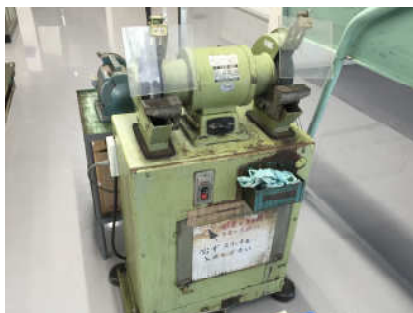
20. 淀川電気製作所製双頭工具グラインダー 型式: 205S 最大回転数(rpm): 3000 台数: 4
