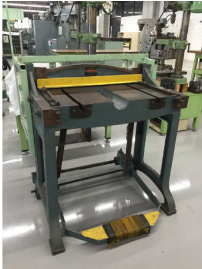
16. 春日橋製作所製板金用切断機 切断能力(mm): 2(アルミ、銅)、1(鉄) 台数: 1
