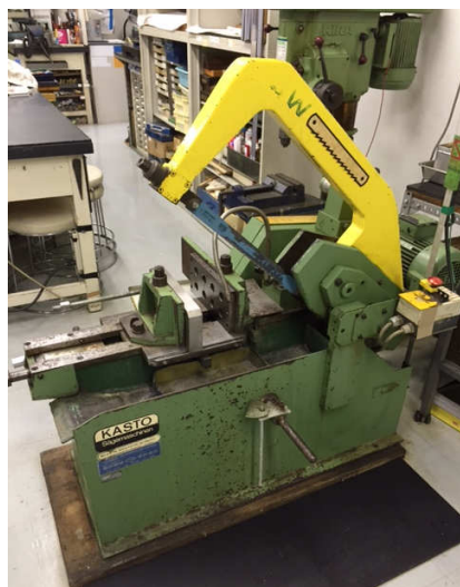
22. KASTO製電動弓ノコ盤 刃長(mm): 400 台数: 1
