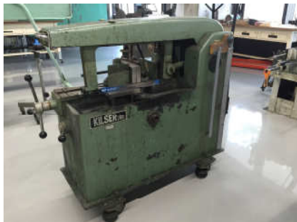
21. 村橋製作所製油圧式電動弓ノコ盤 型式: KLSER200 刃長(mm): 350 台数: 1
