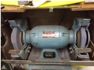
11. 両頭グラインダー 回転数(rpm): 1500 台数: 1
