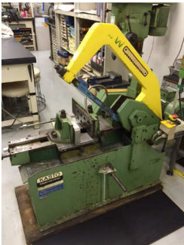
10. KASTO製電動弓ノコ盤 刃長(mm): 400 台数: 1
